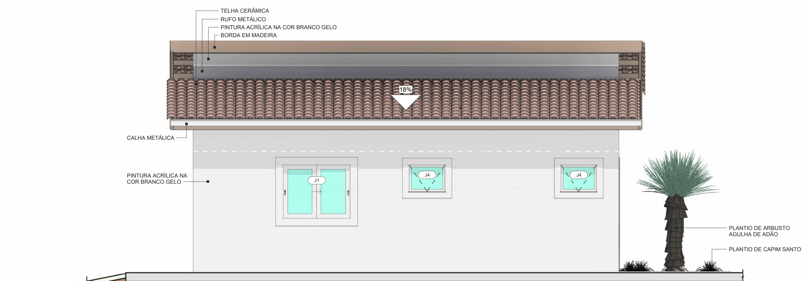
10 FACHADA LATERAL DIREITA ESCALA 1:50
